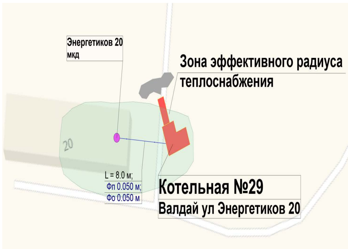
Рисунок 28. Зона эффективного радиуса теплоснабжения котельной № 29
