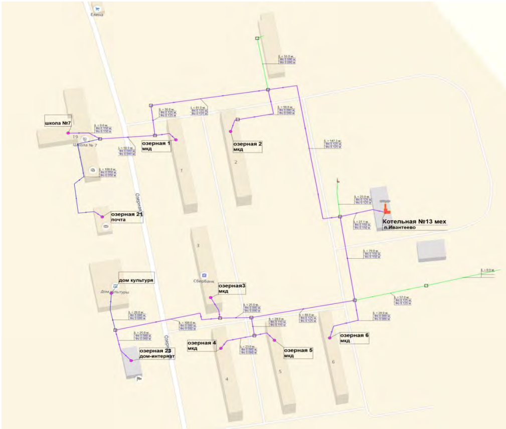
Рисунок 1. Схема тепловых сетей котельной № 13 д. Ивантеево
