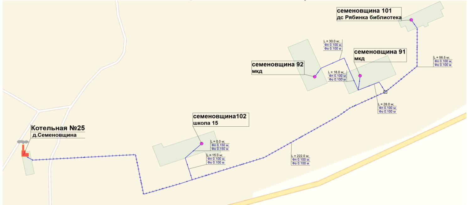
Рисунок 1. Схема тепловых сетей котельной № 25, д. Семеновщина
