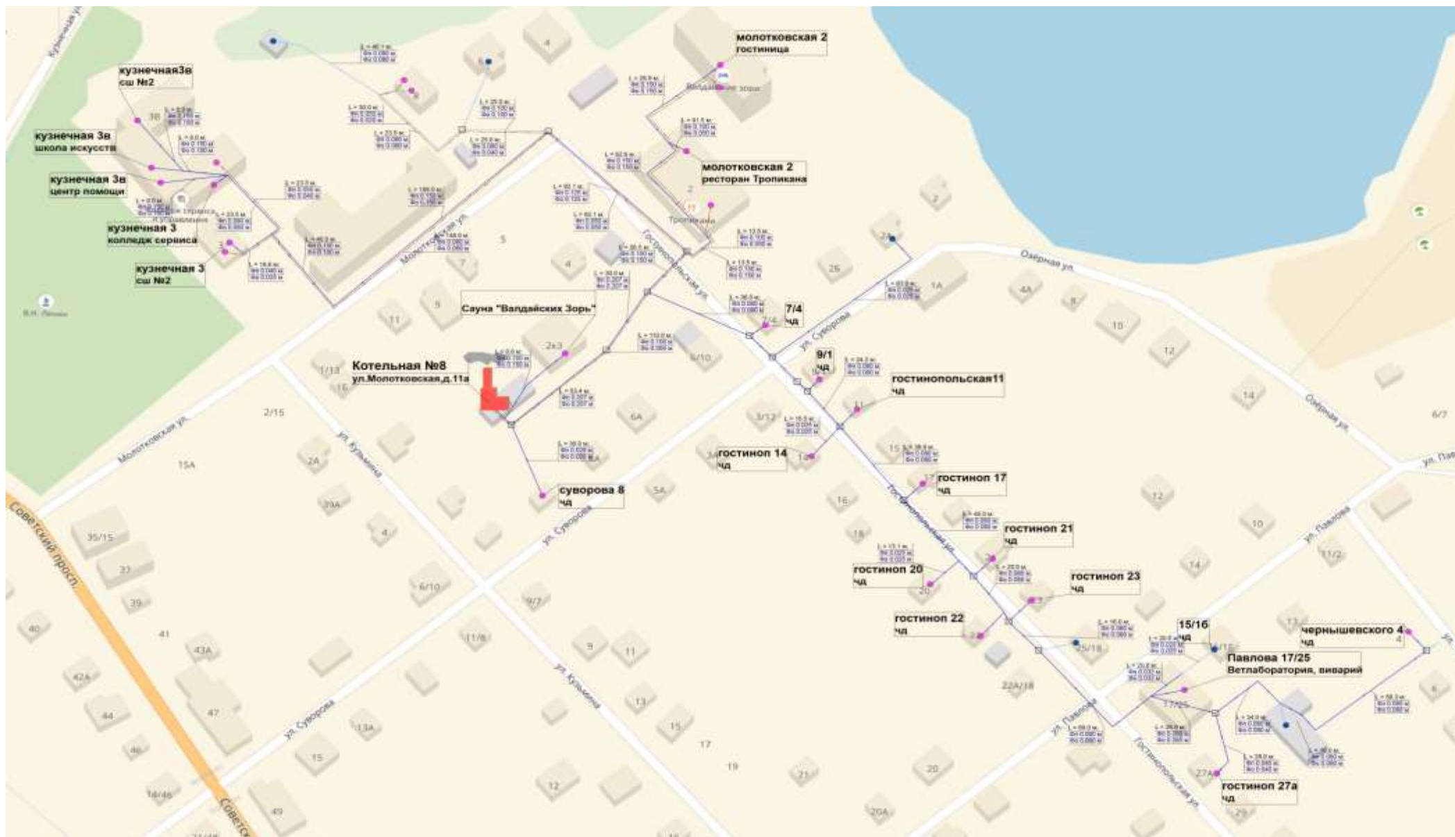
Рисунок 6. Схема тепловых сетей котельной № 8 г. Валдай, ул. Молотковская, д. 11а
