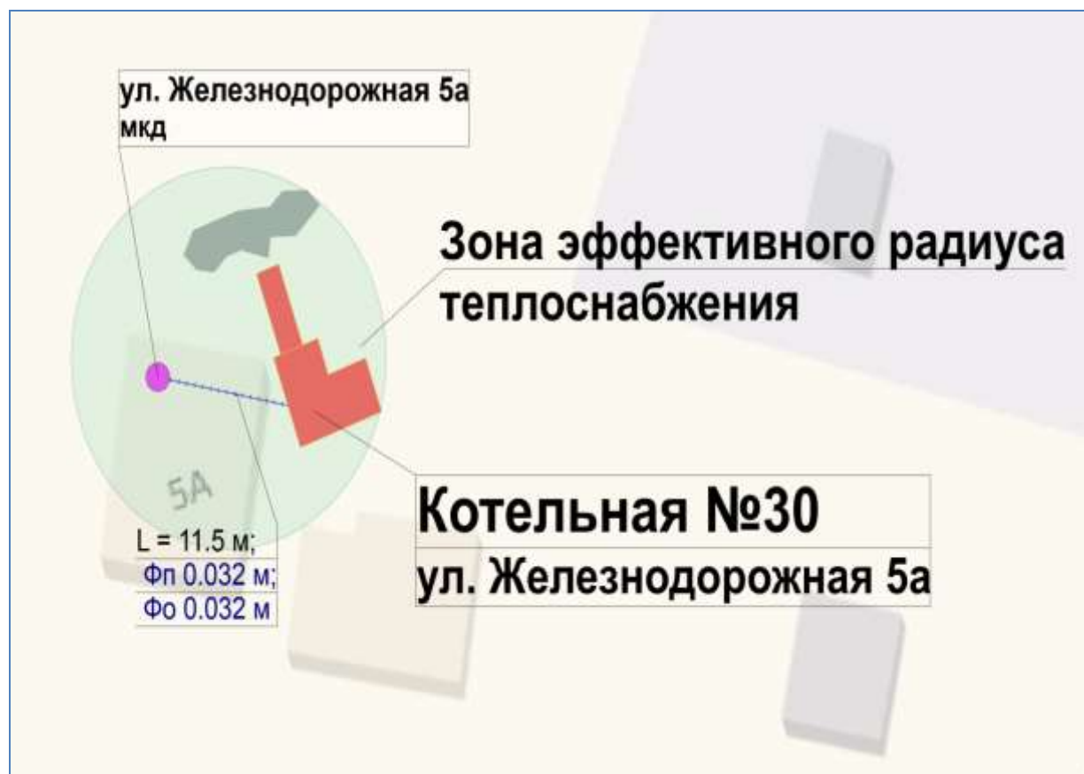
Рисунок 29. Зона эффективного радиуса теплоснабжения котельной № 30
