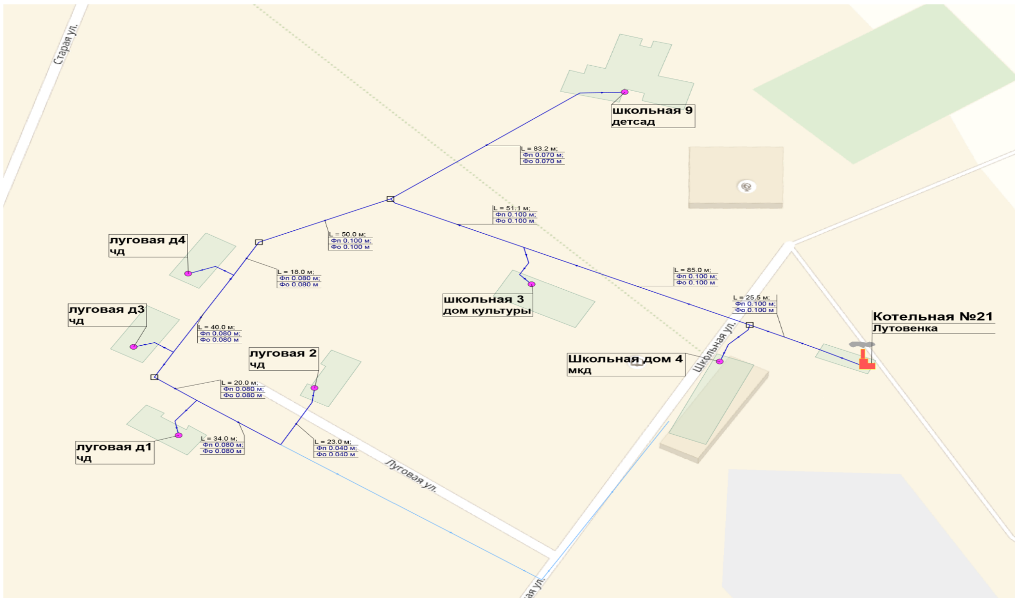
Рисунок 1. Схема тепловых сетей котельной № 21 д. Лутовенка.
