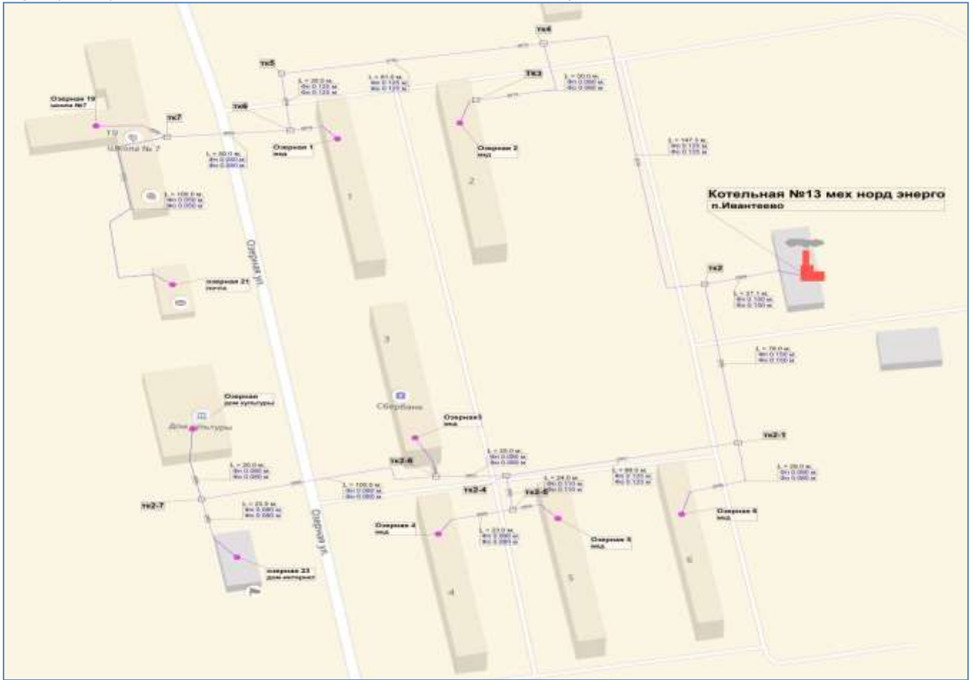
Рисунок 1. Схема тепловых сетей котельной № 13, п. Ивантеево
